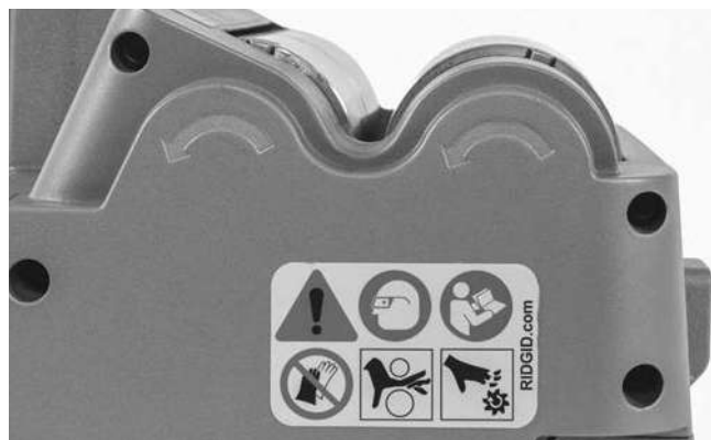
Фигура 5 – Посока на въртене на ролката
