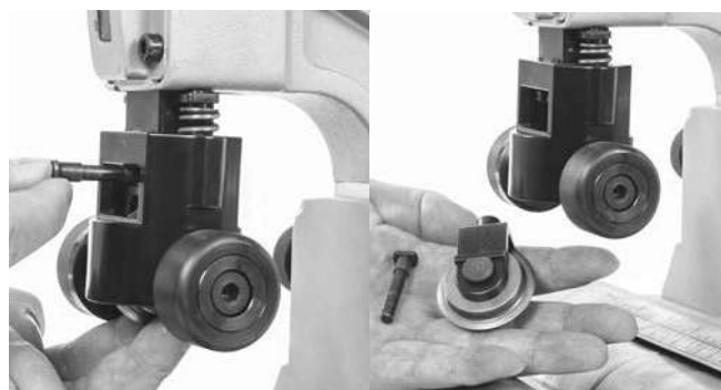
Figur 14 – Fjernelse af hjulholder
