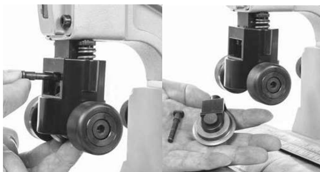
Obrázok 14 – Odstránenie držiaka rezacieho kolieska
