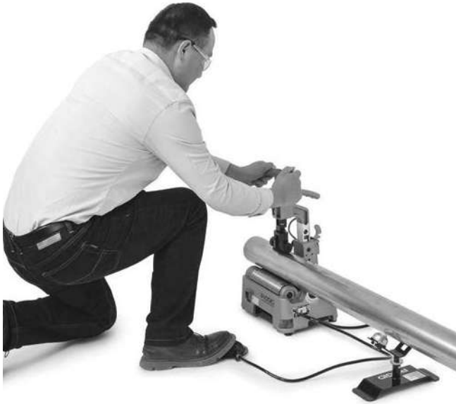
Figur 10 – Kutting av rør
