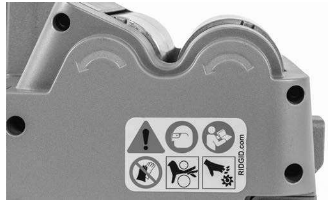
Figura 5 – Dirección de rotación de los rodillos
