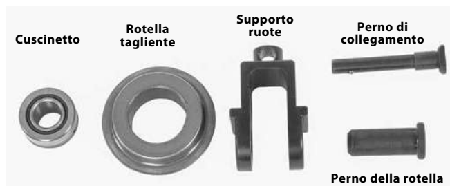
Figura 15 – Sostituzione della rotella tagliente
