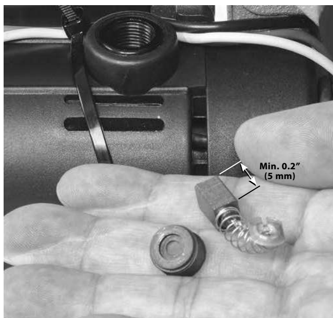
Rysunek 18 – Sprawdzanie długości szczotki
