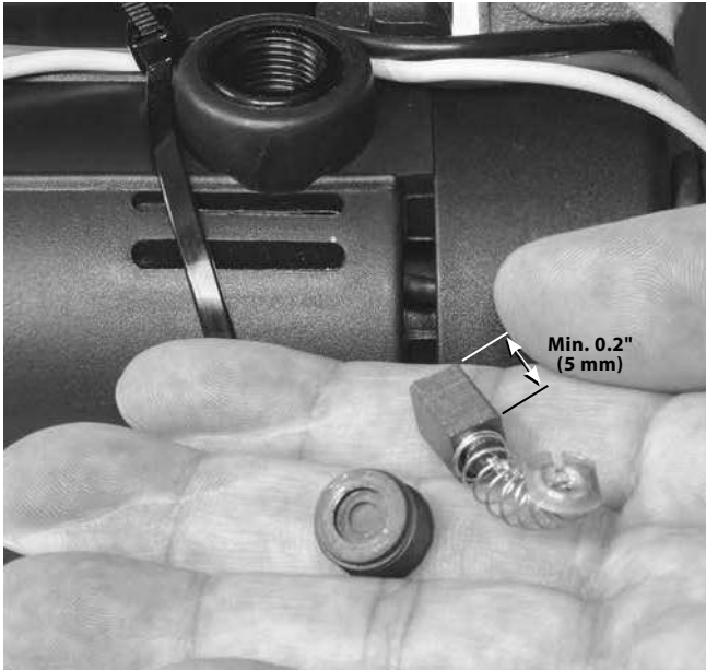
Figur 18 – Kontrol af børstelængde
