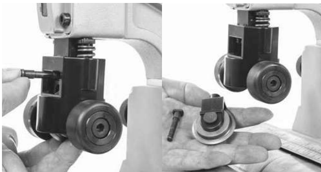
Slika 14 – Uklanjanje držača kotača
