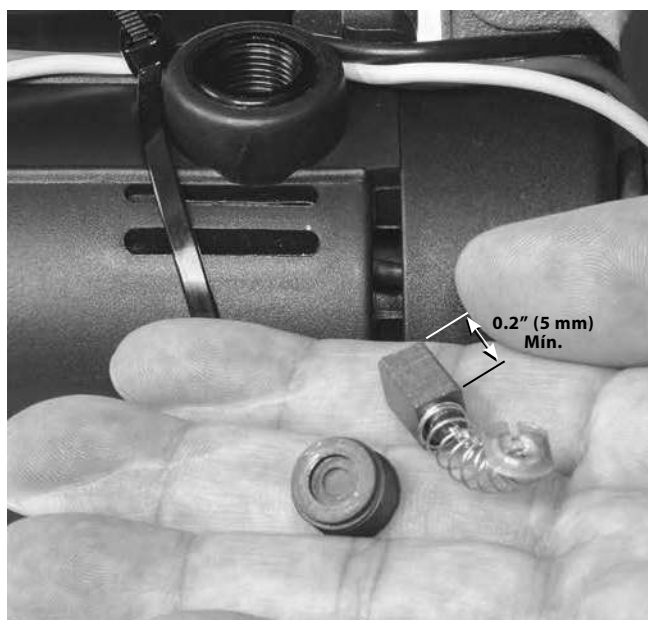
Figura 18 – Inspeccionar o comprimento da escova
