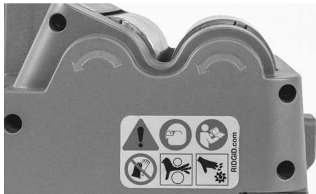
Figura 5 – Sensul de rotație al rolelor
