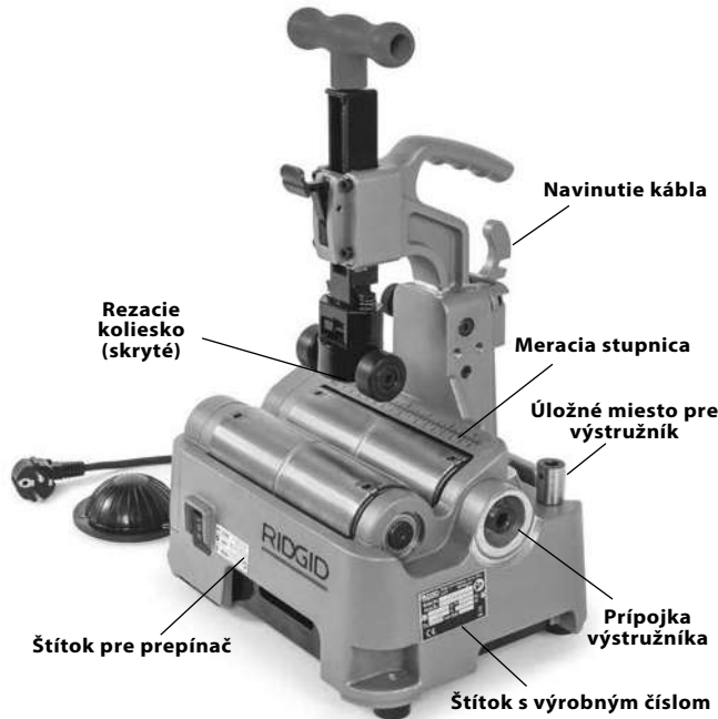
Obrázok 1 – Elektrická rezačka rúr RIDGID® PC116/PTC-400
