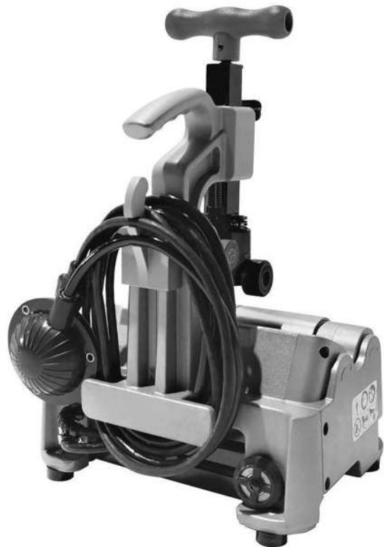
Εικόνα 13 – Τυλιγμένο καλώδιο/εύκαμπτος σωλήνας
