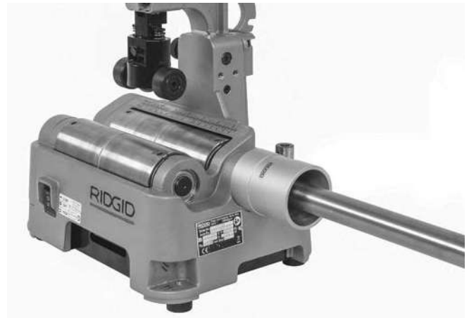
Figur 12 – Fjerning av grader i rør
