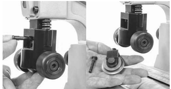
Slika 14 – Skidanje držača točka
