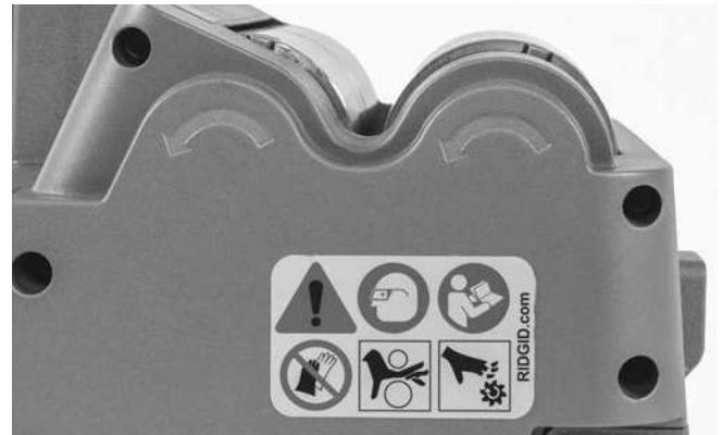
Obrázek 5 – Směr otáčení válečku
