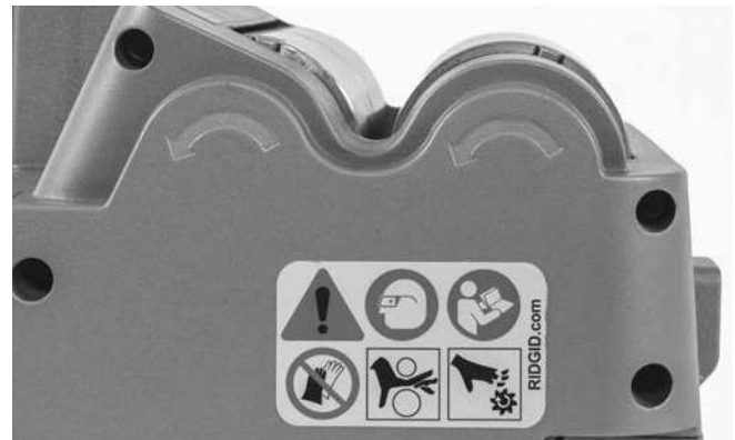
Abbildung 5 – Rotationsrichtung der Rollen
