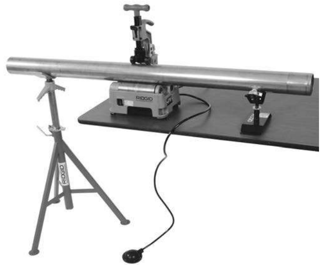
Figuur 3 – Opstelling van de steun
