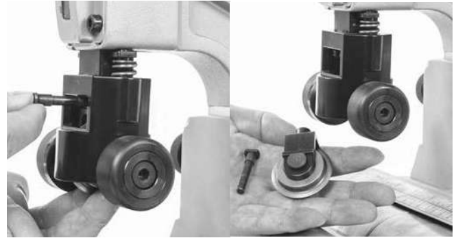
Şekil 14 – Tekerlek Tutucunun Sökülmesi
