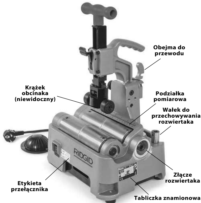
Rysunek 1 – Elektryczny obcinak do rurek PC116/PTC-400 RIDGID®
