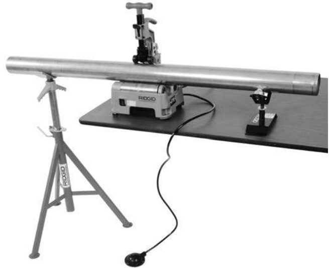
Figura 3 – Colocación del soporte
