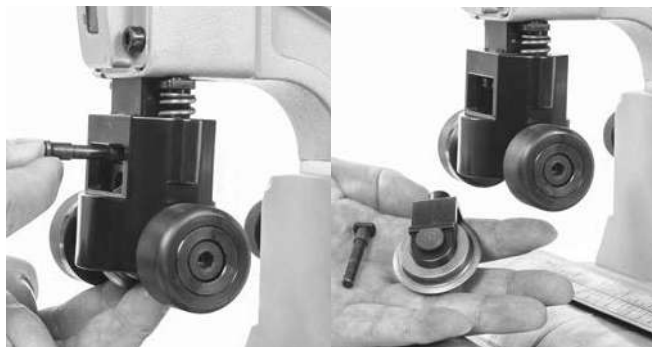
Obrázek 14 – Demontáž držáku kolečka
