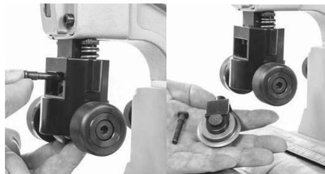
Figura 14 – Retirar o suporte de roda
