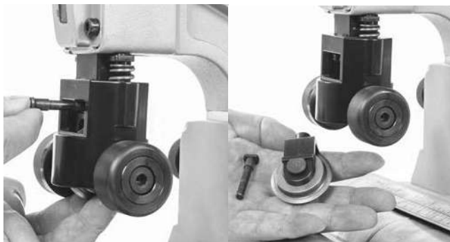
14. ábra – Görgőtartó eltávolítása
