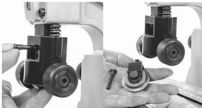
Figura 14 – Rimozione del supporto delle ruote
