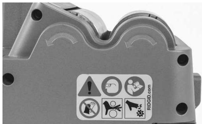
Figura 5 – Direção de rotação do rolete
