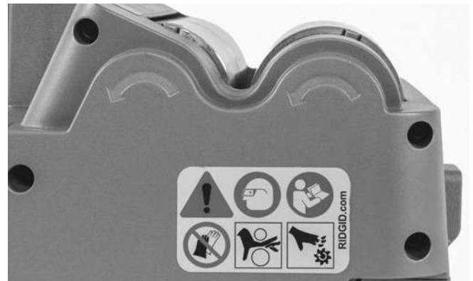
Figuur 5 – Draairichting rollen
