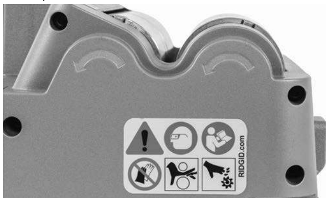
Figure 5 – Sens de rotation des galets d'entraînement
