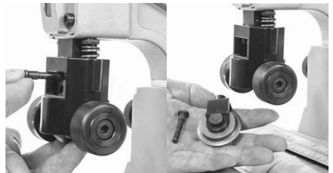
Рис. 14 - Снятие держателя режущего ролика
