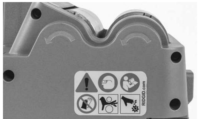
Slika 5 – Smjer okretanja valjaka
