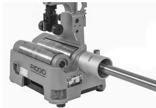
Figura 12 – Alesatura delle tubazioni
