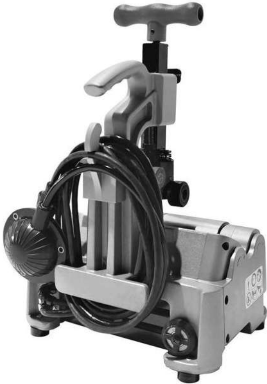
Rysunek 13 – Zwinięty przewód elektryczny / wąż
