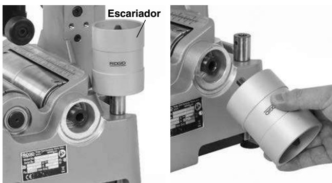
Figura 11 – Instalación del escariador
