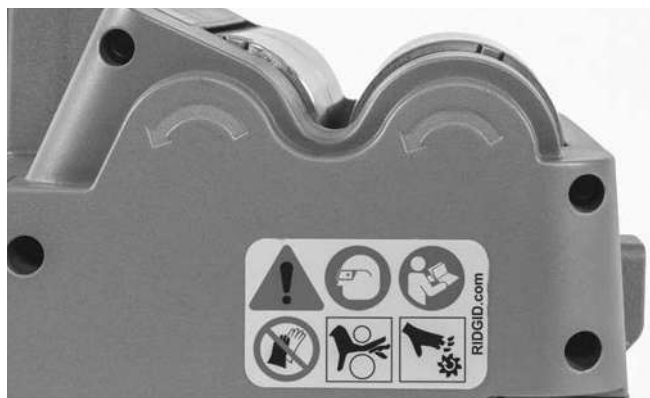
Figura 5 - Direzione di rotazione dei rulli
