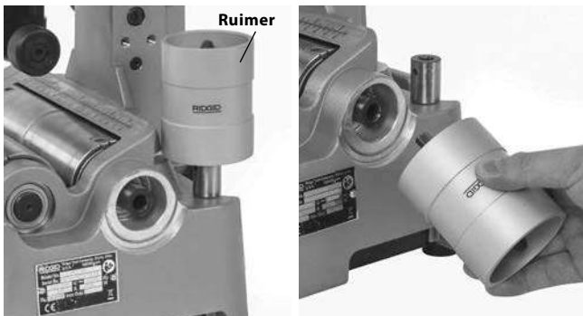
Figuur 11 – Ruimer installeren
