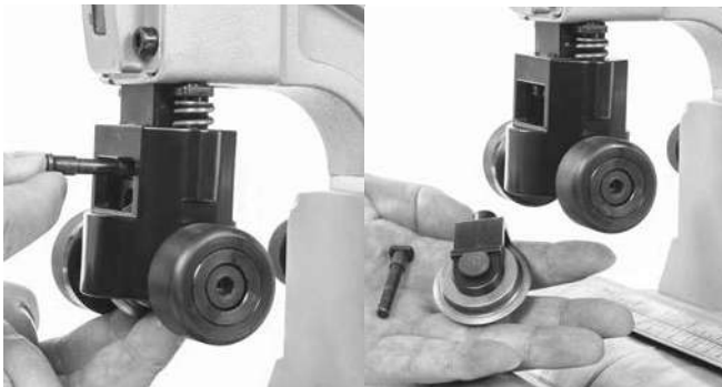
Εικόνα 14 – Αφαίρεση βάσης μαχαιριού
